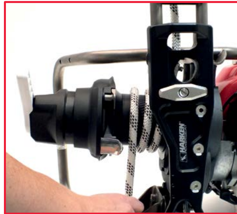
8. avvolgere in senso orario la fune attorno alla campana del winch
