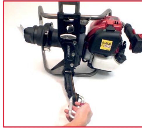
6. fissare la fettuccia al punto di ancoraggio inferiore
