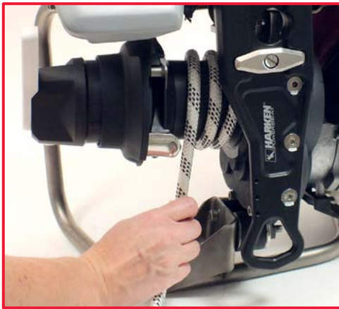
7. avvolgere in senso orario la fune attorno alla campana del winch
