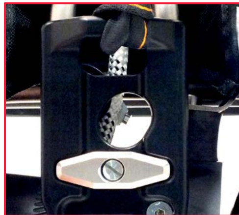
6. verificare che la fune sia stata infilata correttamente nella propria sede
