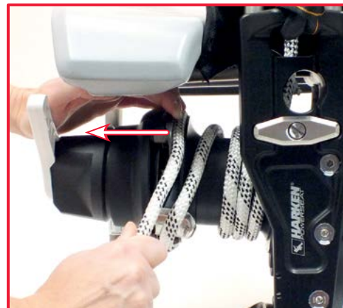
9. far passare la fune fra le due semipulegge. Per agevolare l'operazione sollevare il coperchio
