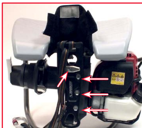
Ispezionare tutte le viti e verificare che il marker che contrassegna la posizione delle viti non abbia subito alterazioni che potrebbero indicare una modifica nel corretto serraggio delle stesse. Qualora si riscontri una anomalia provvedere a contattare un centro di assistenza HARKEN.
