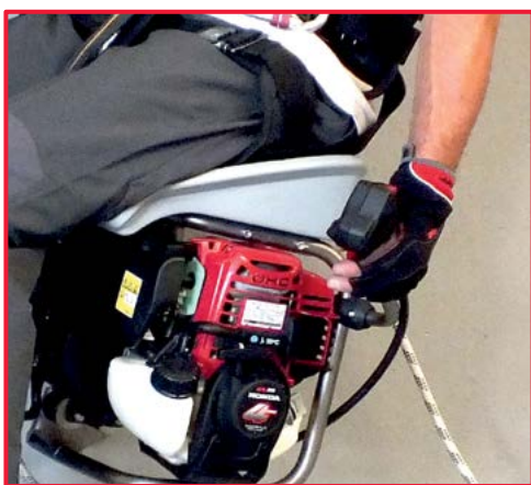
8. adattare la posizione del comando accelerato in modo tale che essa sia confortevole per l'operatore e sia collocata lontano dagli scarichi del motore.
