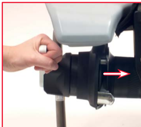
Controllare la funzionalità della leva di controllo delle semipulegge ruotandola e rilasciandola (SEMIPULEGGIA CHIUSA).
