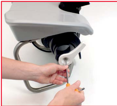
1. allentare la vite della leva di controllo
