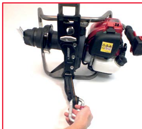
4. fissare la fettuccia al punto di ancoraggio inferiore
