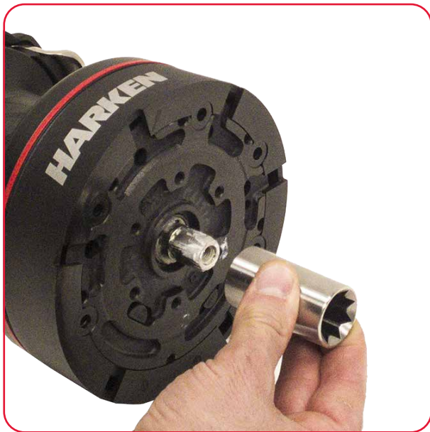
4. Posizionare l'innesto maniglia sull'albero.
