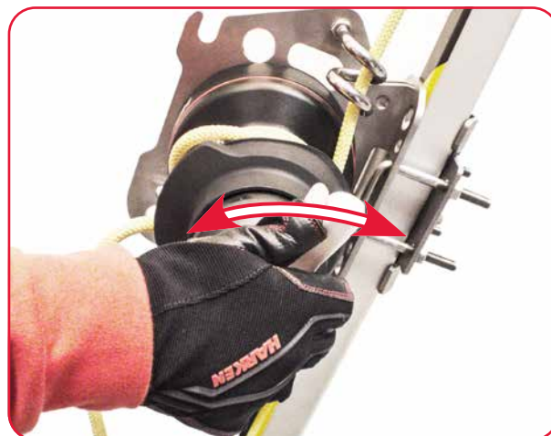
Controllare la funzionalità della leva di controllo delle semipulegge ruotandola e rilasciandola.
