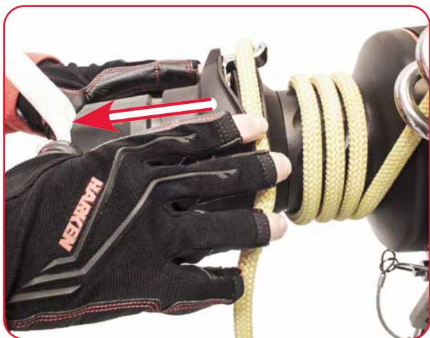
Verificare la mobilità del coperchio delle semipulegge.
