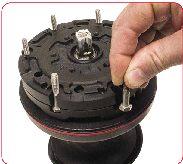
Note: le viti 1/4" a testa esagonale non sono adatte per questa procedura.
