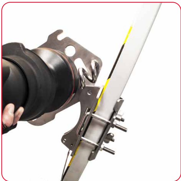
4. Posizionare la piastra su cui è installato il Winch sulla piastra adattatore tripode.
