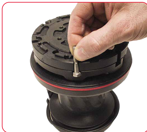
2. Rimuovere la gonna e posizionare le 5 viti a testa esagonale M6 nei loro fori
